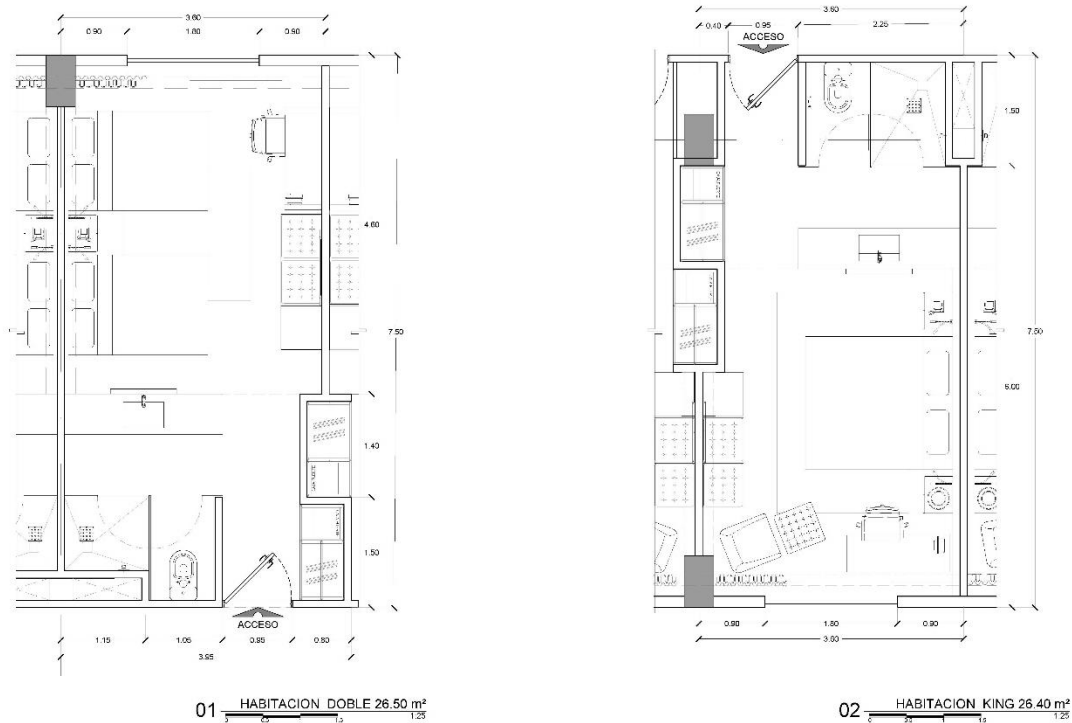
Figura 11. Planta de conjunto de las habitaciones tipo proyectadas en el Hotel La Isla Cancún. Fuente: Promovente.
