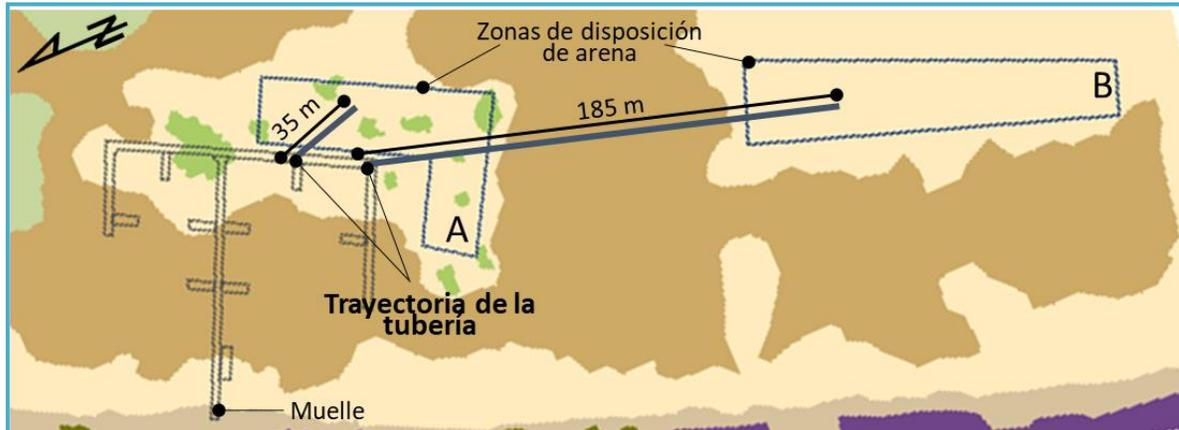
Figura II\_ 35. Esquema de la trayectoria de la tubería.
