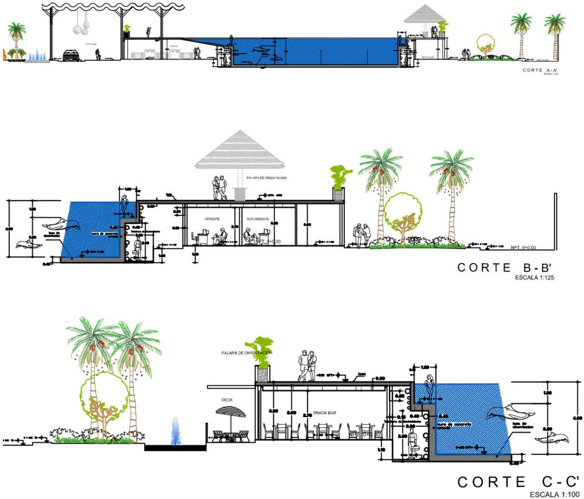
Figura 4. Cortes de transversales de la alberca.
