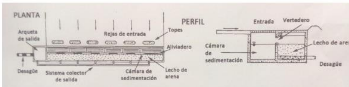
Imagen 7. Detalle de los filtros de grava y arena en rejillas de drenaje pluvial.
