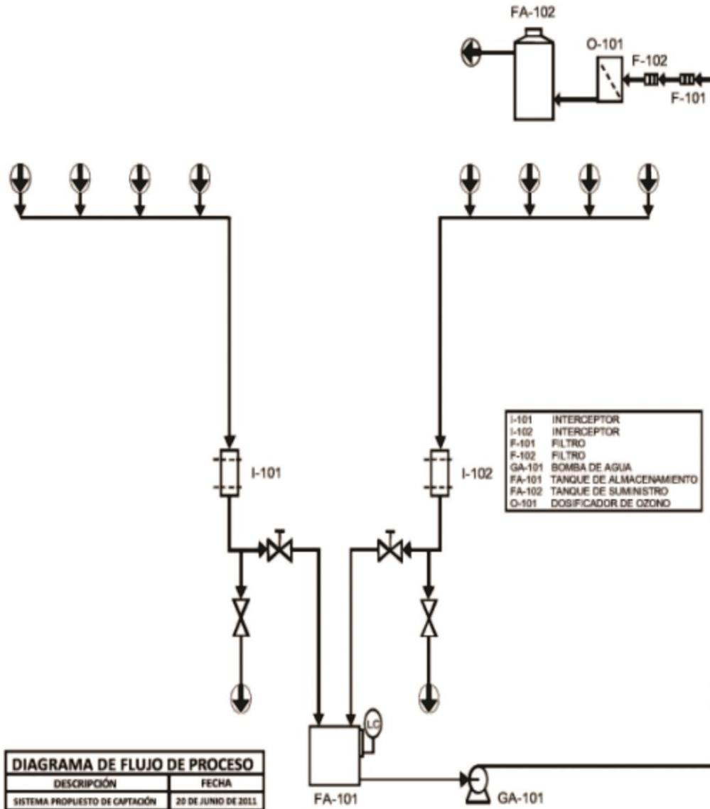
Figura 9 Esquema del sistema de captación de agua de lluvias
