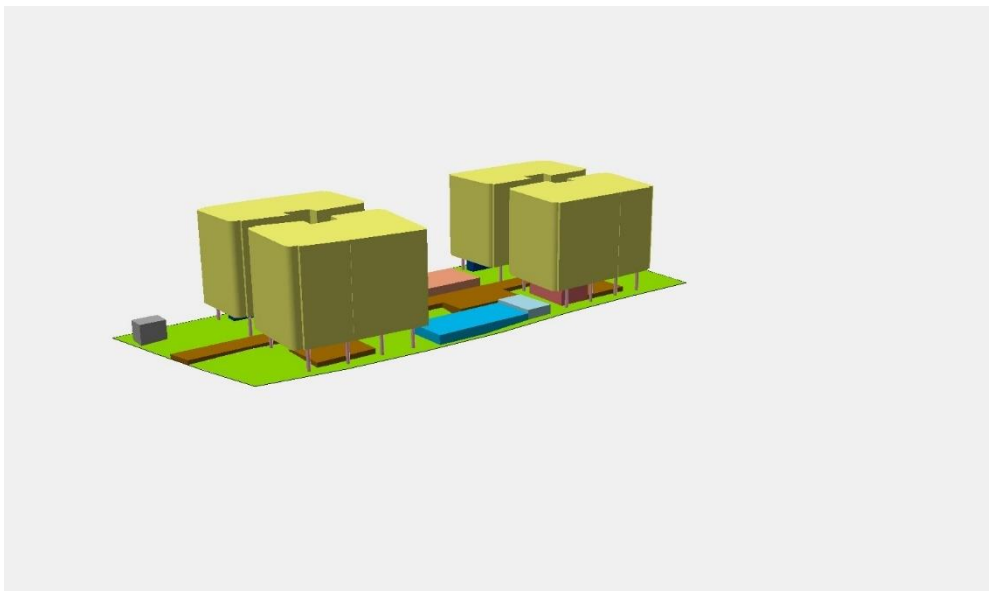
Imagen III-8 El proyecto se plantea soportado por pilotes por lo que el contacto de éste con el suelo resulta mínimo.
