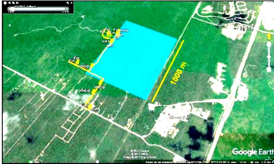
Figura No.19.- Estimación de la longitud de la franja de 1,000 m para la determinación de la transmisividad con un espesor saturado de 3m, en la zona de Chemuyil, Tulum, Quintana Roo.
