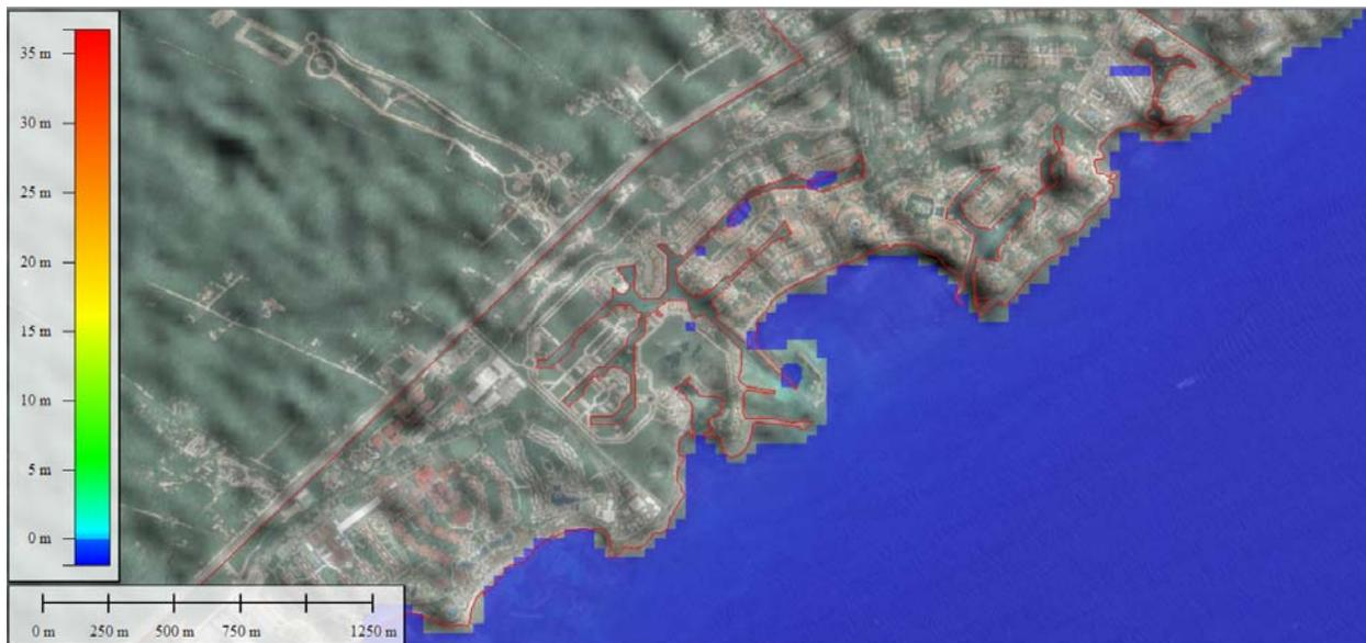
Figura IV.21.- Resultados de modelos de inundación. 1.5 a 3.5 m de incremento del nivel del mar.
