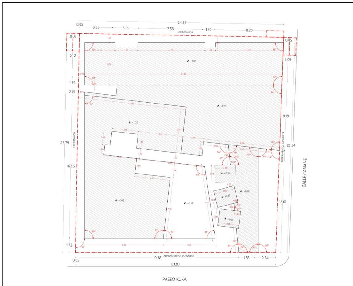
Figura 3 Huella de desplante del proyecto sobre la superficie del terreno
