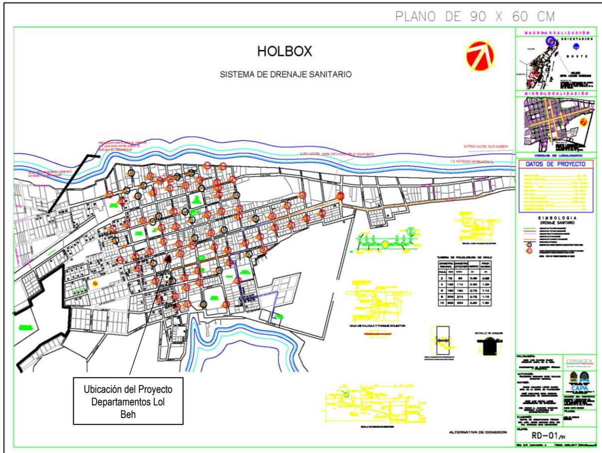
Figura 4 plano de ubicación de registros de las tomas de drenaje existentes en la Isla de Holbox
