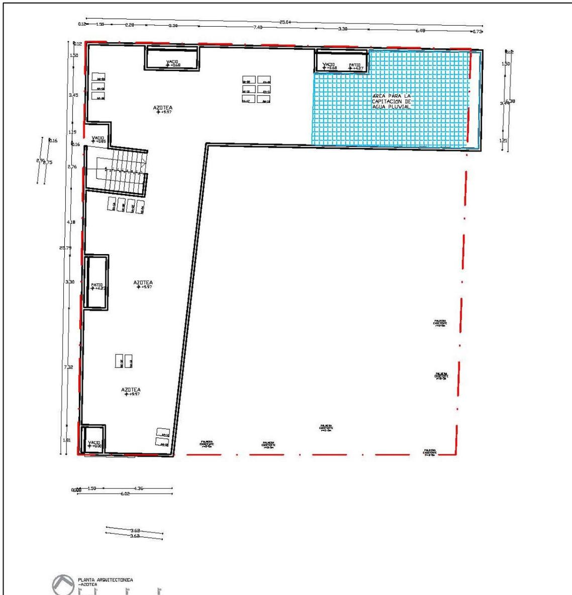
Figura 9 plano del área del techo donde se observa el área destinada para la captación de agua pluvial (azul)
