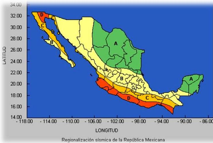
**Imagen 4.** Regionalización Sísmica de la República Mexicana. **A:** Bajo riesgo sísmico. **B:** Mediano riesgo sísmico. **C:** Alto riesgo sísmico. **D:** Muy alto riesgo sísmico. **Fuente:** Servicio Sismológico Nacional.
