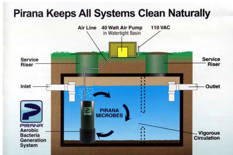
Figura II.3 Sistema Piraña. Equipo ya instalado en la cisterna o tanque de agua residual.
