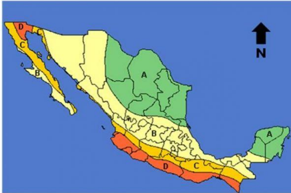
Figura 19 Regionalización sísmica de México. Izquierda: en base al Servicio Sismológico Nacional (2007), la zona A se representa en verde.
