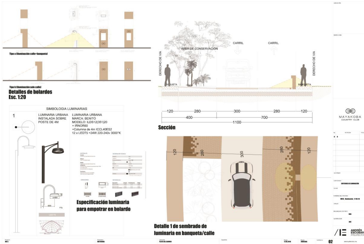
Figura 2. 26. Características técnicas de las luminarias.
