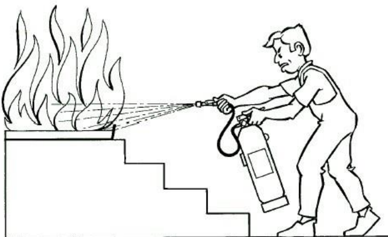
Figura 6.1. Reglas generales de uso de un extintor de incendios portátil. Tomada de Ministerio de Trabajo y Asuntos Sociales. Instituto Nacional de Higiene y seguridad en el Trabajo. Sin fecha. NTP: 536: Extintores de incendio portátiles: utilización.
