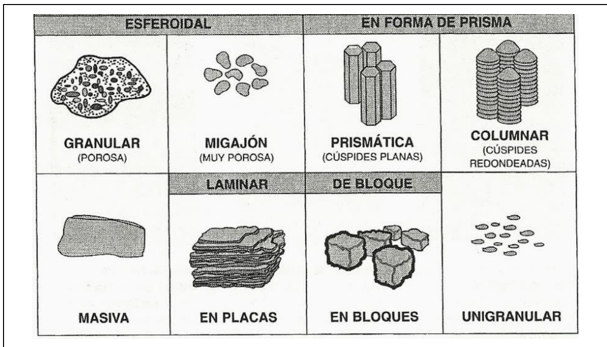
Figura IV-23. Tipos de estructuras de un suelo.
