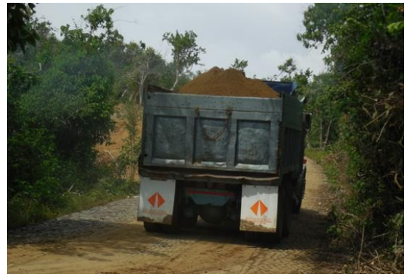
Transporte de material sin protección para evitar la resuspensión de partículas
