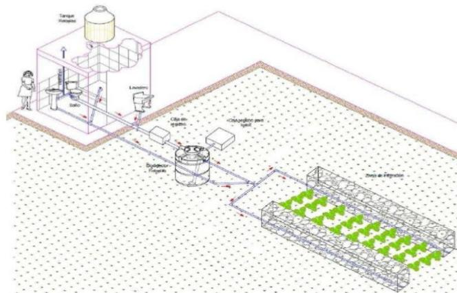
Figura 28. Imagen que esquematiza el funcionamiento del biodigestor y su conexión con el humedal artificial.
