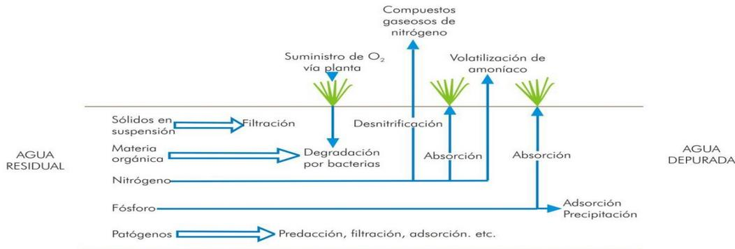
Figura 30. Proceso de depuración de los humedales artificiales. Fuente: Lara y Salgot, 1999.
