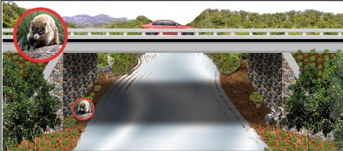
Figura II.4. Obra hidráulica con franjas secas para el paso de la fauna
