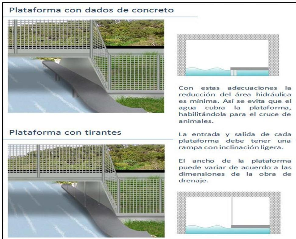
Figura II.5 Plataformas de concreto
