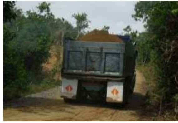
Transporte de material sin protección para evitar la resuspensión de partículas
