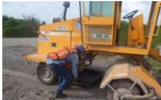
Protección contra fugas de hidrocarburos de maquinaria estacionada.
