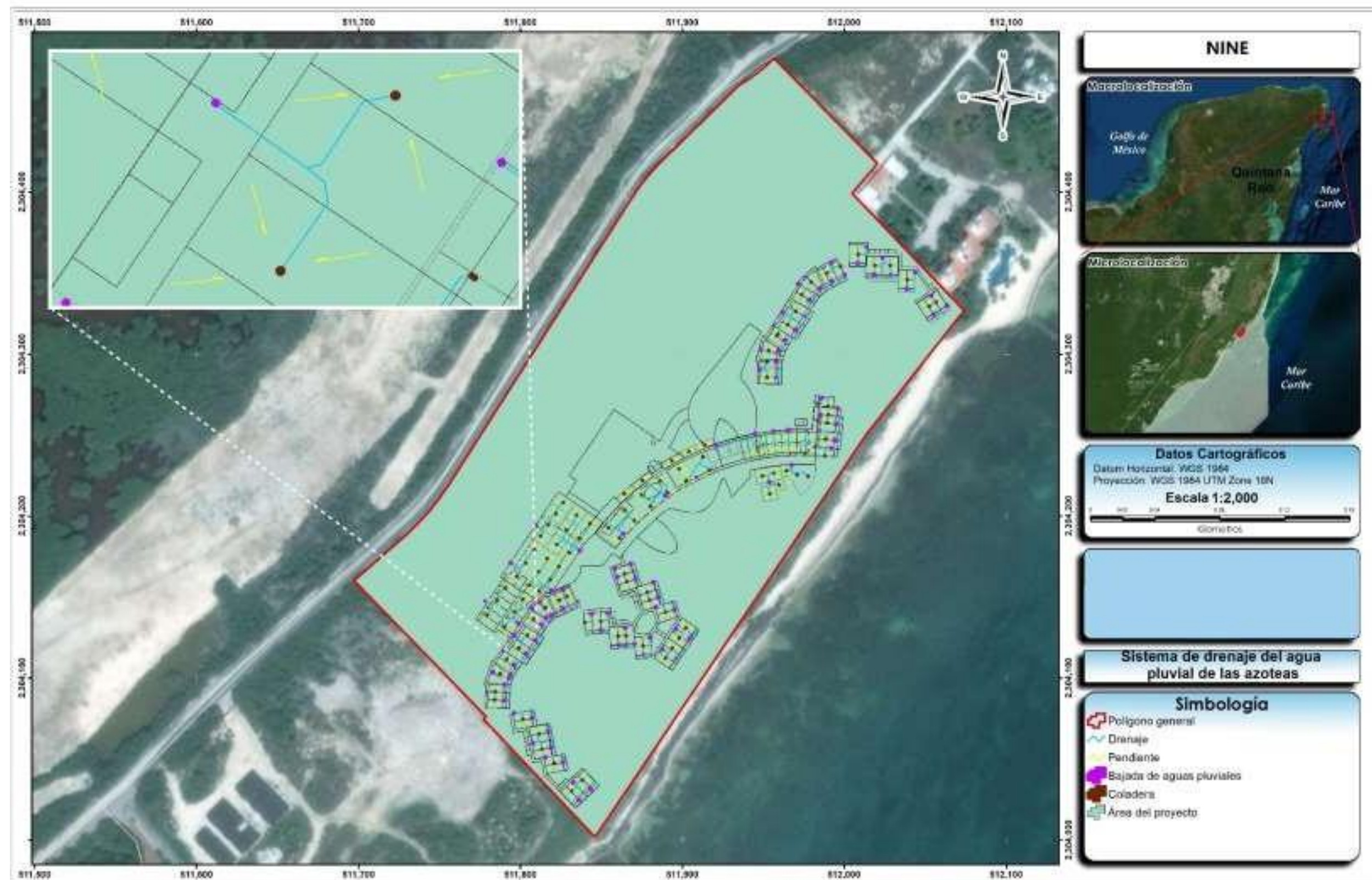
Figura 30 Diseño y conformación del sistema de captación y conducción de agua pluvial en las azoteas de las obras que conforman el proyecto.
