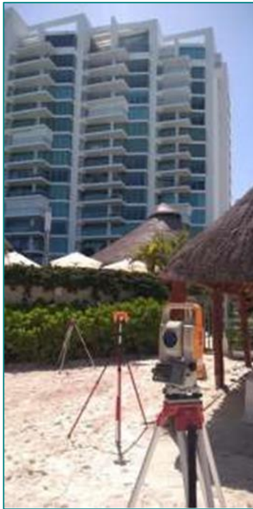
FIGURA 4.11 EQUIPO EMPLEADO EN EL LEVANTAMIENTO TOPO/BATIMETRÍA (ESTACIÓN TOTAL Y PRISMA)
