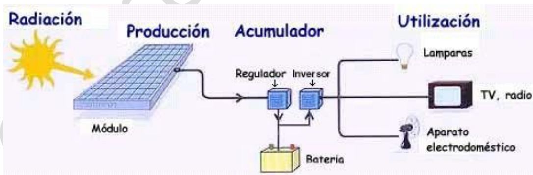
Figura 11.- Instalación solar fotovoltaica con inversor
