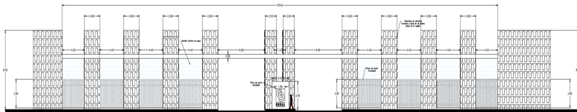
Figura 9. Vista acceso principal del proyecto “Parque ecoturístico”, se puede apreciar las dimensiones de las columnas de carga 4.00 m por 2.70 m, así como la glorieta principal que contiene una pirámide secundaria de 21.20 m de diámetro.
