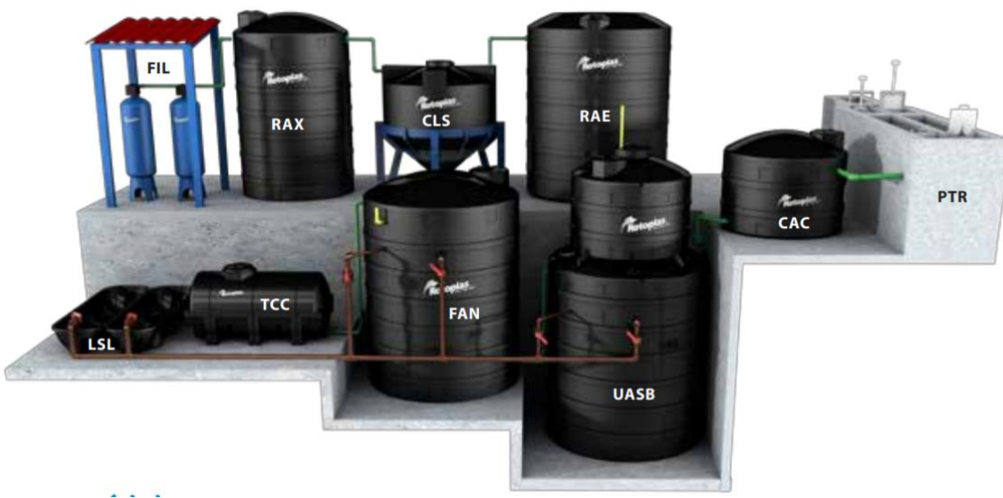
Figura 21. Sistema de planta de tratamiento (PTAR) propuesto para el manejo de los módulos de sanitarios.
