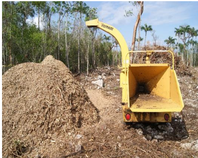
Figura 2. 41. Trituración de los residuos vegetales
