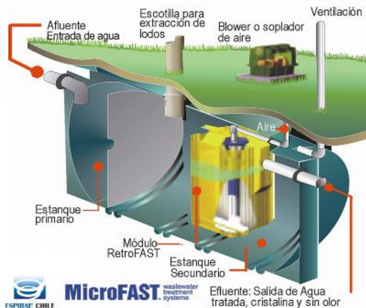
Figura 14. Esquema del diseño y acomodo de los componentes de una PTAR MicroFAST genérica (no pertenece al diseño del proyecto en cuestión).
