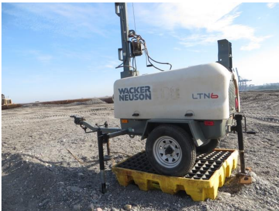
Protección de equipos contra fuga de hidrocarburos
