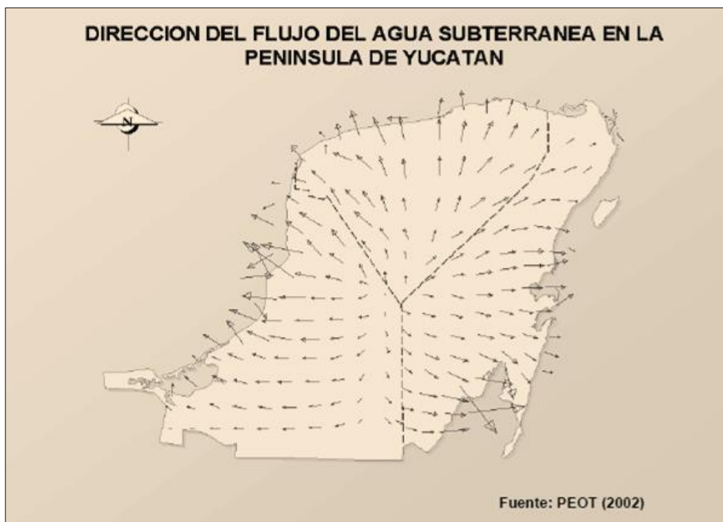
Figura 10. Dirección del flujo de agua subterránea. La dirección general del flujo subterráneo en la península es a partir de la parte más alta que se localiza en la sección central de la misma, hacia el Oriente, Sur, Norte y poniente con componentes hacia el Surtes, Noroeste y Noreste.
