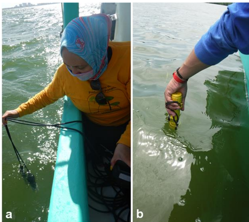
Figura 8.30. Determinación de parámetros fisicoquímicos. a) Determinación de temperatura, pH, con una sonda multiparamétrica. b) Determinación de la profundidad.
