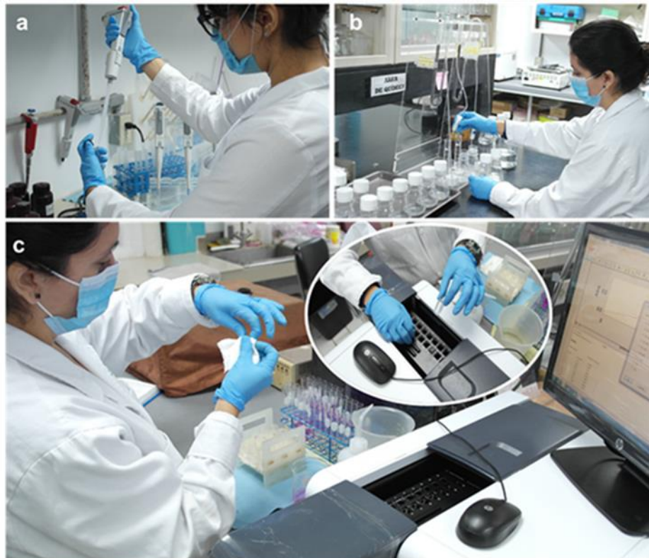
Figura 8.35. a) Preparación de muestras para análisis de nutrientes; b) Reducción de nitratos a nitritos empleando una columna cadmio-cobre para la cuantificación de nitratos; c) Lectura de muestras por espectrofotometría UV/VIS.
