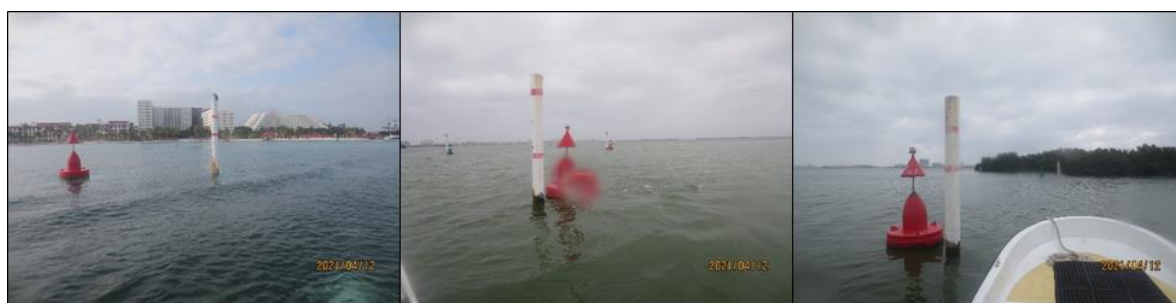
Figura 8.26. Fotografía de las balizas donde se instalan los sensores de presión.
