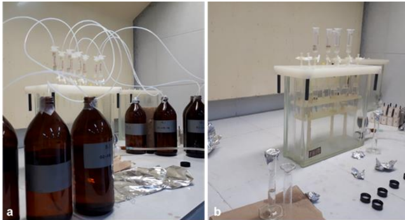
Figura 8.38. Análisis de muestras de cafeína obtenidas en el Sistema Lagunar Nichupté-Bojórquez. a) Extracción durante la EFS realizada en el laboratorio y b) Elución durante la EFS.
