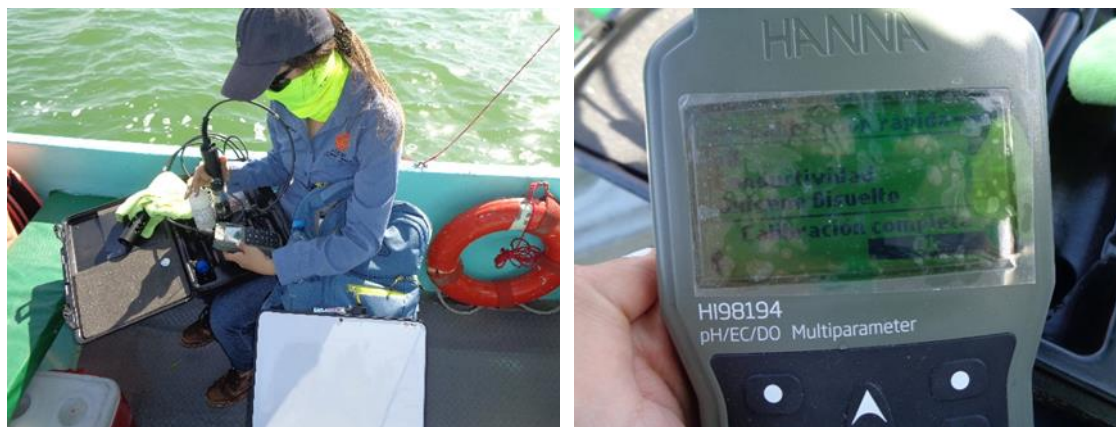
Figura 8.4. Ejemplo de calibración en campo del equipo multiparamétrico previo a las mediciones de los parámetros físicos del agua.
