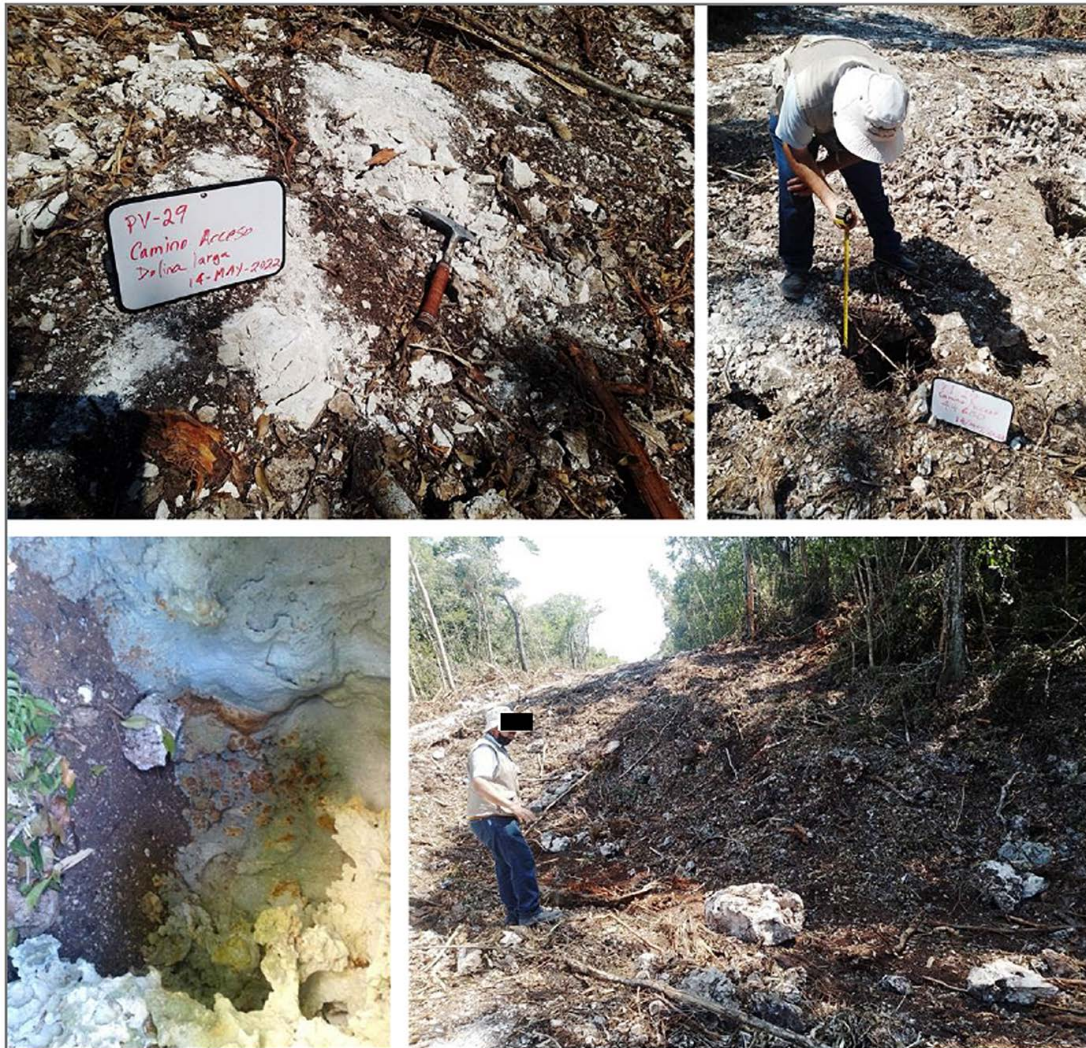
Figura IV.2.1.84. Afloramiento de caliza en dolina cubierta por material de terrarrosa.
