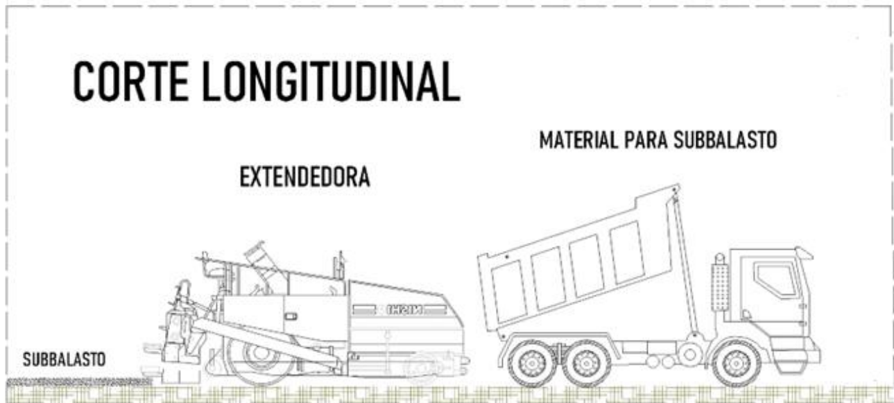
Figura II.59: Corte longitudinal para conformación de sub-balasto. Opción 2.
