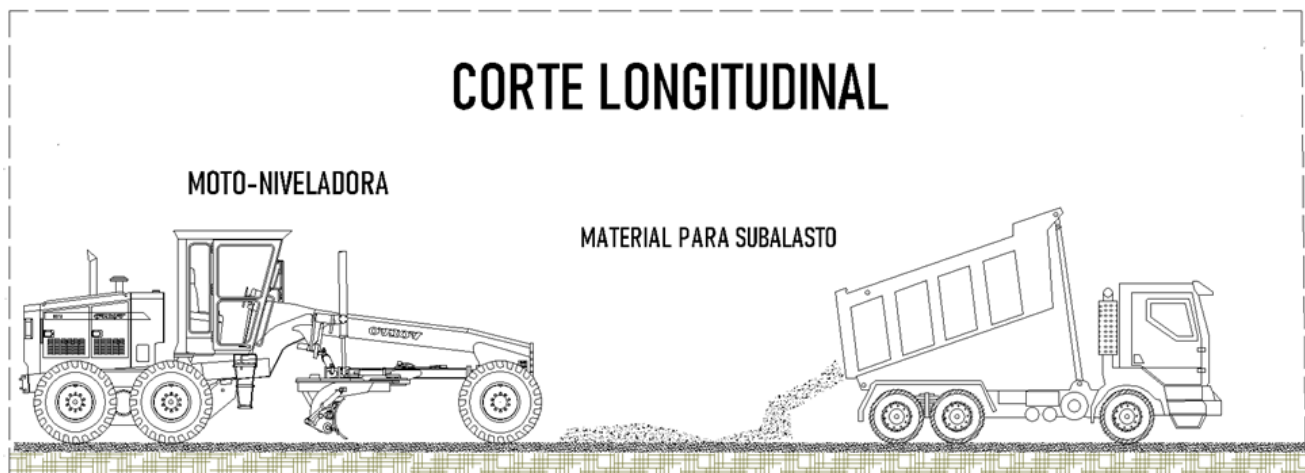
Figura II.57: Construcción de sub-balasto, imagen representativa.
