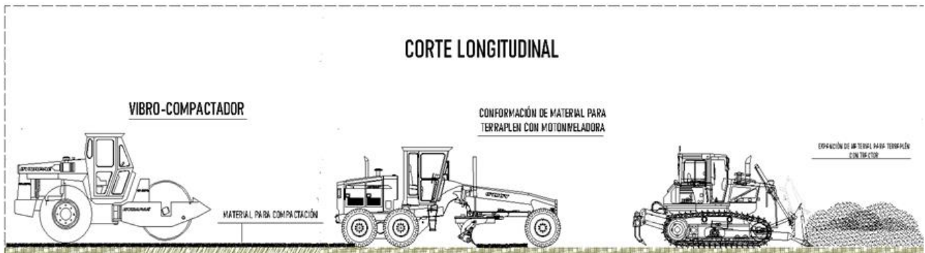
Figura II.55: Conformación de terraplén, corte longitudinal, imagen representativa.
