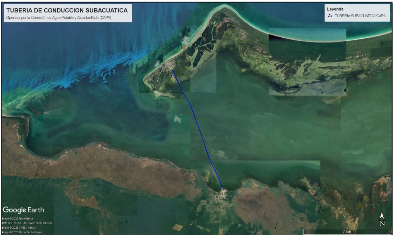
Figura 4. Suministro y distribución de agua desde la zona continental de Chiquilá hacia Holbox. Tubería de conducción subacuática 19 km. De longitud.
