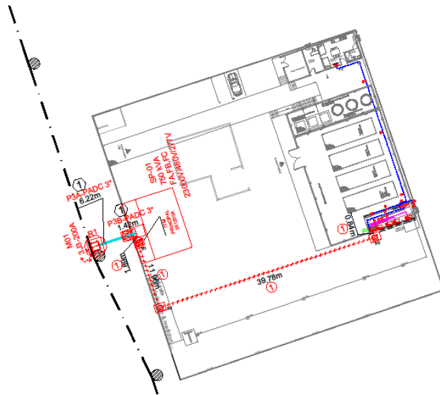
Figura 6. Plano de instalaciones eléctricas del proyecto.
