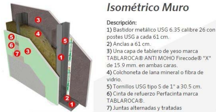
FIGURA 2.114 REPRESENTACIÓN GRÁFICA DEL SISTEMA COSNTRUCTIVO DE TABLAROCA/DUROCK
