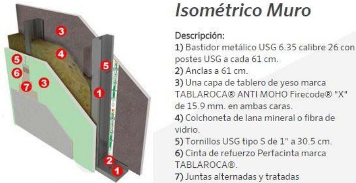
FIGURA 2.111 REPRESENTACIÓN GRÁFICA DEL SISTEMA COSNTRUCTIVO DE TABLAROCA/DUROCK
