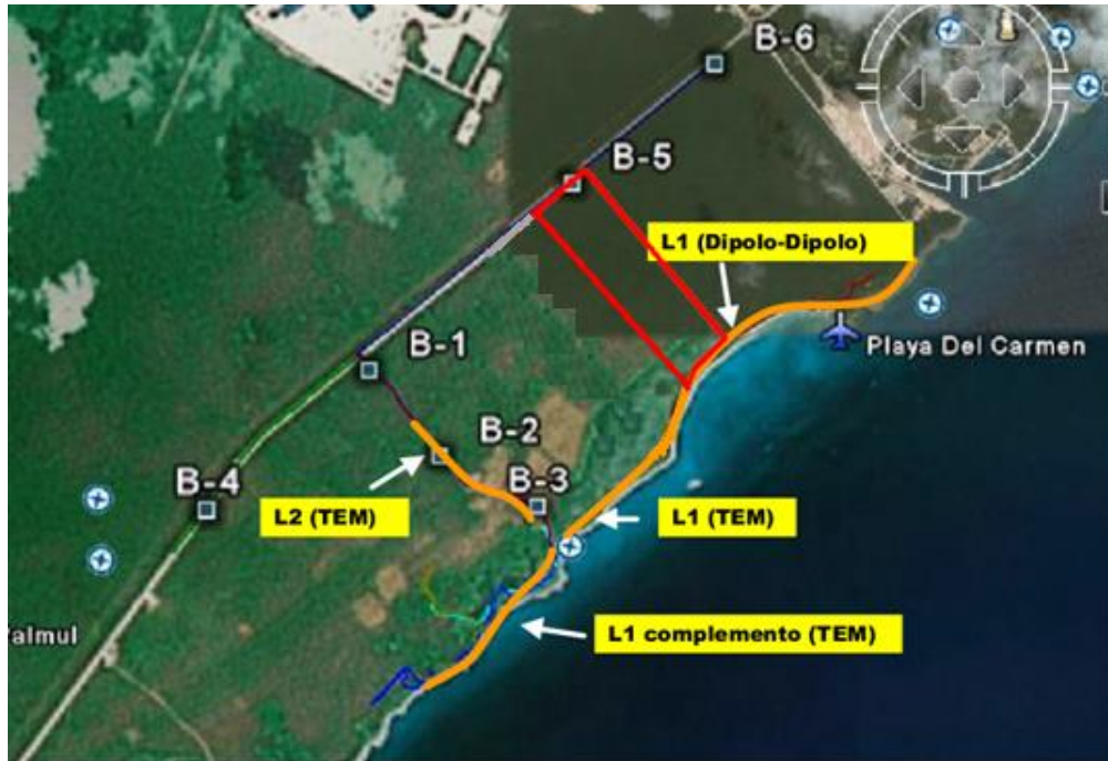
Figura IV.19 Ubicación de las líneas para los sondeos geofísicos y los puntos de barrenación.
