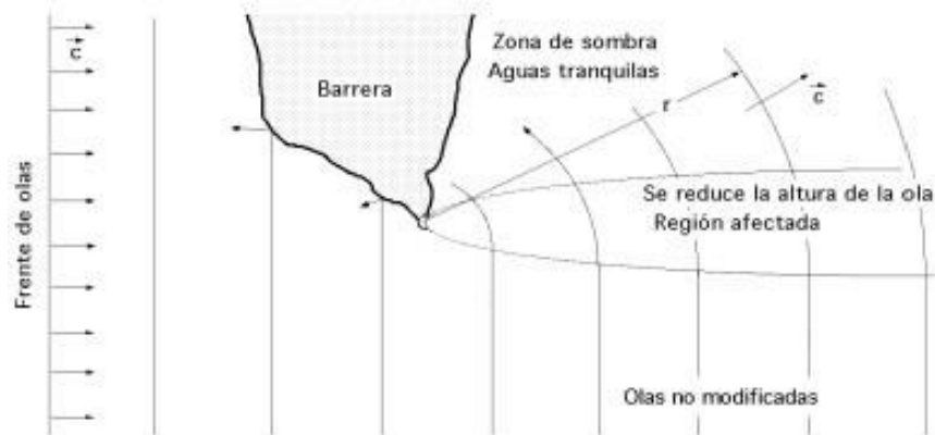
Figura 6-22. Difracción de las olas al encontrar un saliente marino. Las olas pasar al otro lado de la barrera, adoptando un frente en forma circular y disminuyendo su altura, mientras que su velocidad y longitud de onda no se modifican.
