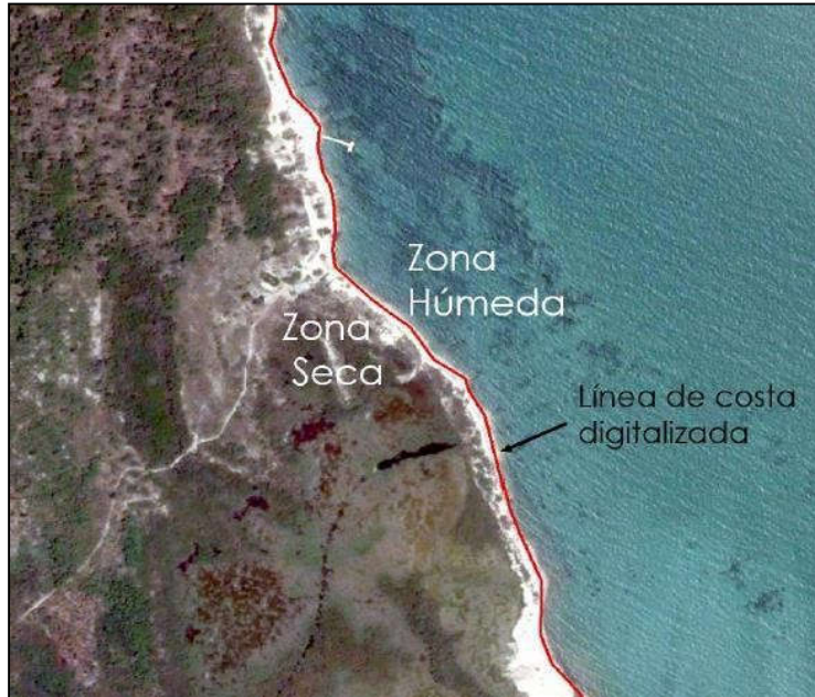
Figura 6-29. Ejemplo de digitalización de línea de costa, tomando como criterio el límite de zona húmeda/seca
