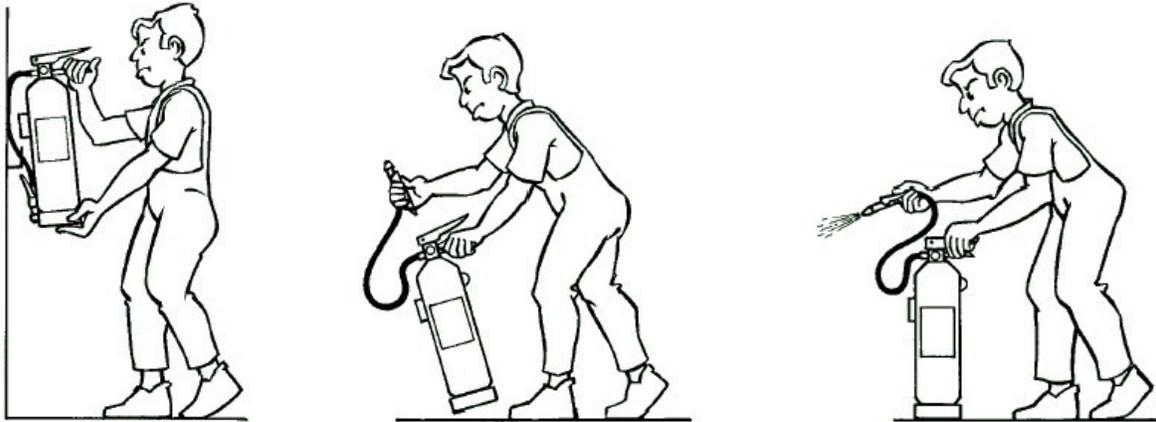
1. Descolgar el extintor asiéndolo por la maneta o asa fija y dejarlo sobre el suelo en posición vertical.
