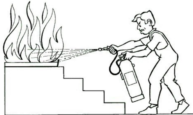
Dirigir el chorro a la base de las llamas con movimiento de barrido. En caso de incendio de líquidos proyectar superficialmente el agente extintor efectuando un barrido evitando que la propia presión de impulsión provoque derrame del líquido incendiado. Aproximarse lentamente al fuego hasta un máximo aproximado de un metro.
