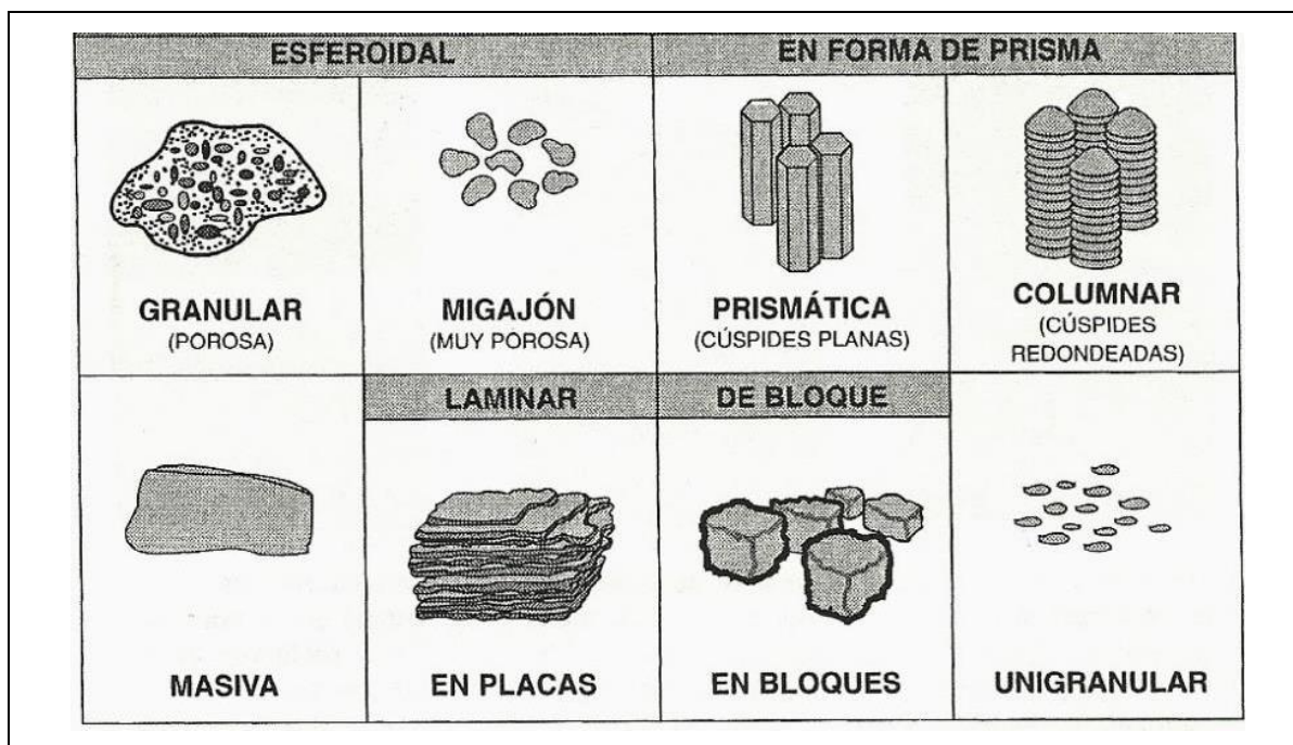
Figura IV-24. Tipos de estructuras de un suelo.
