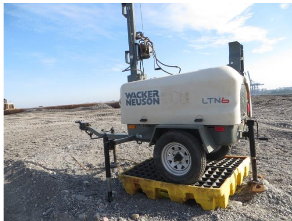
Protección de equipos contra fuga de hidrocarburos
