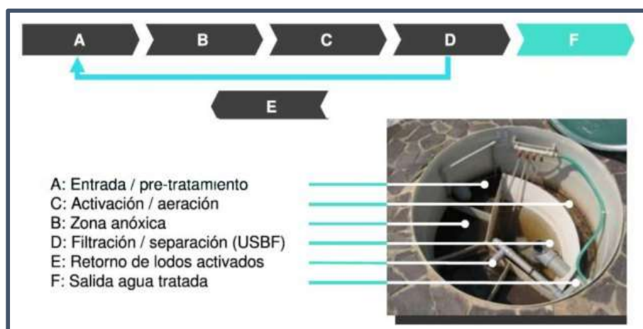
Imagen 2.9. Esquema del tren de tratamiento de la línea DR AT. Imagen tomada del portal de la empresa gpsmx.
