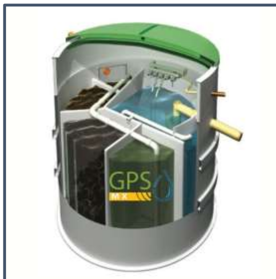
Imagen 2.8. Esquema del diseño de la línea DR AT. Imagen tomada del portal de la empresa gpsmx.
