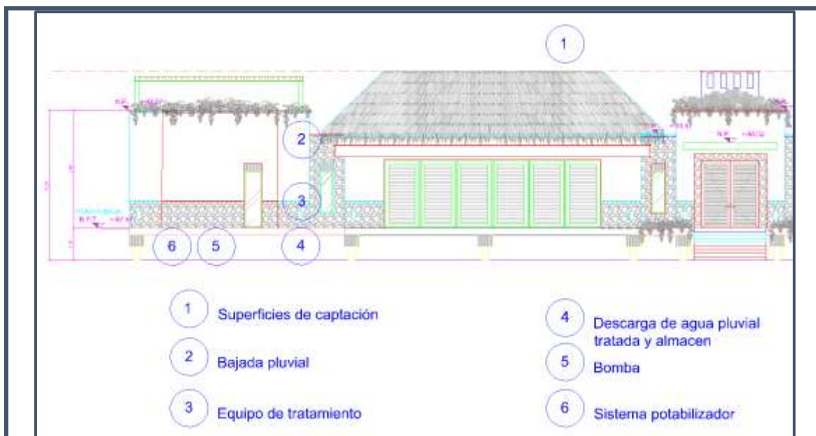
Imagen 3.5. Sistema de captación pluvial en techos de 2 y 4 aguas y azoteas planas.
