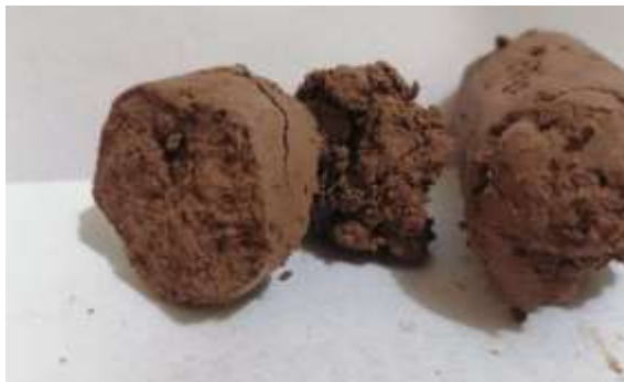
UE1 Arcilla color café consistencia de media a muy firme de profundidad variable desde superficie hasta 13m en algunas zonas.
