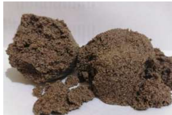
UE4 Arena fina con limo color café con compacidad de compacta a muy compacta con una profundidad variable de 13.60m a 25.2 metros
