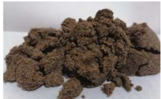
UE2. Arena fina con limo color café compacidad variable de media a compacta de una profundidad variable de 3.60 m a 8.40 m aproximadamente
