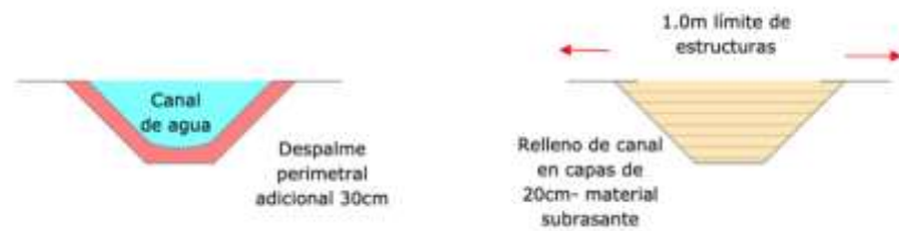
Figura 5. Esquema del relleno de canales
