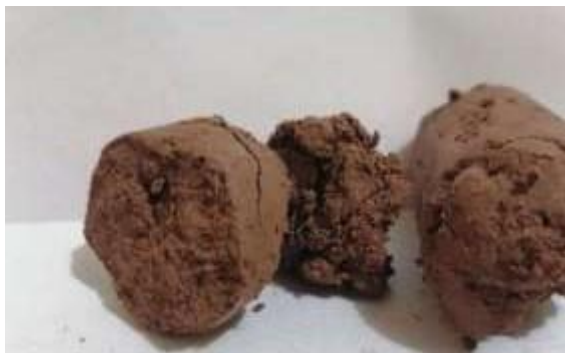
UE1 Arcilla color café consistencia de media a muy firme de profundidad variable desde superficie hasta 13m en algunas zonas.
