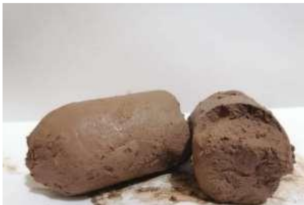
UE3. Arcilla de color café consistencia variable de media a muy firme con una profundidad variable de 11.40 m a 20.40 m aproximadamente
