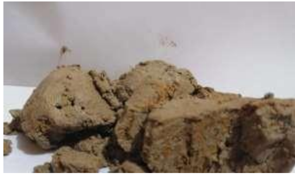
UE5 Limo color gris consistencia variable de firme a dura con una profundidad de 22 a fin de sondeo, en promedio
