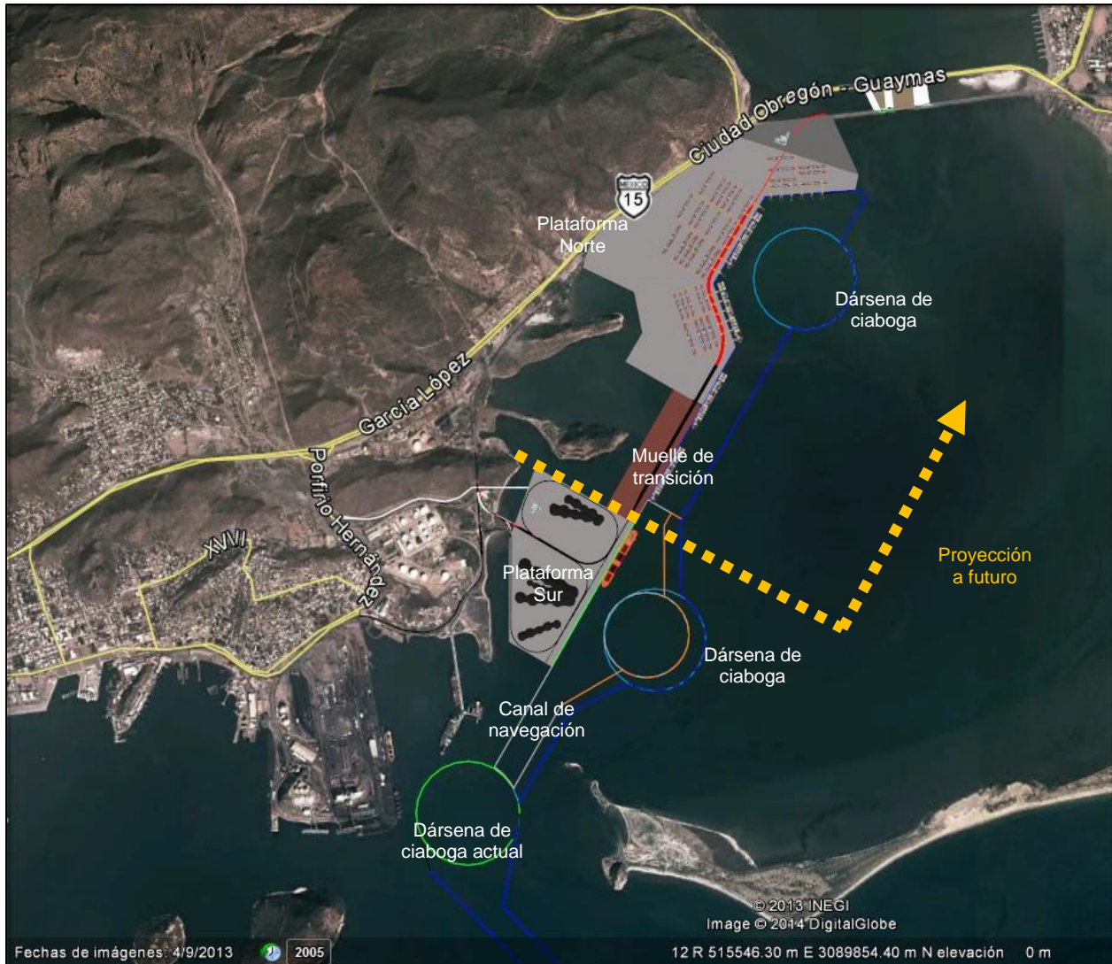
Figura 5. Vista de planta de plataforma norte, muelle de transición y plataforma sur del proyecto integral para la expansión del Puerto de Guaymas, Sonora.
