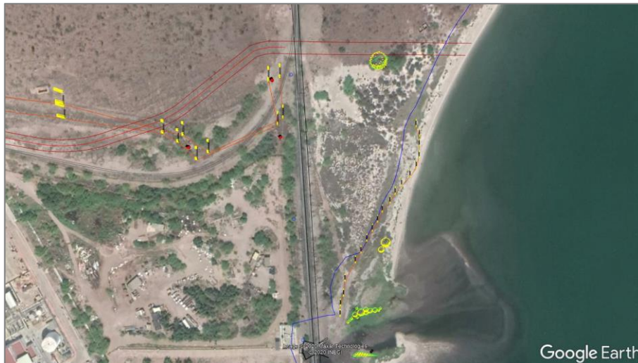
Figura 34. Imagen de satélite donde se muestra el trazo registrado en campo para las balizas de señalamiento sobre la playa del poliducto de PEMEX en el sitio del proyecto de expansión del Puerto de Guaymas, Sonora.
