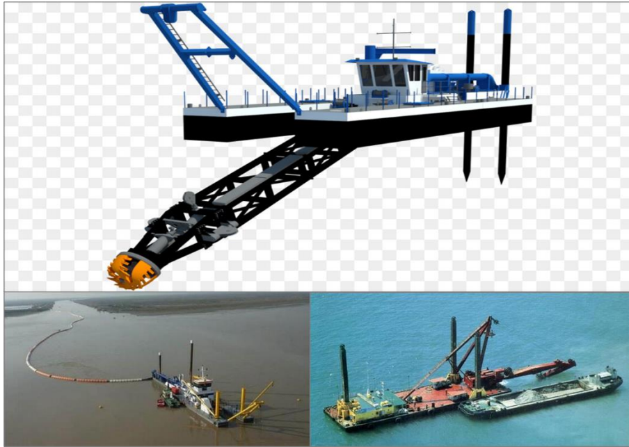
Figura 23. Ejemplo de draga CSD para bajas profundidades.
