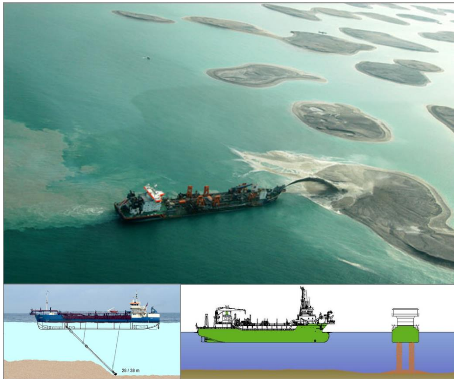
Figura 24. Dragas TSHD autopropulsada.
