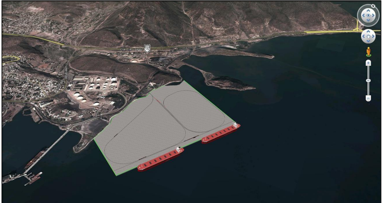
Figura 8. Plataforma sur unida a la configuración de la línea de costa para la expansión del Puerto de Guaymas, Sonora.
