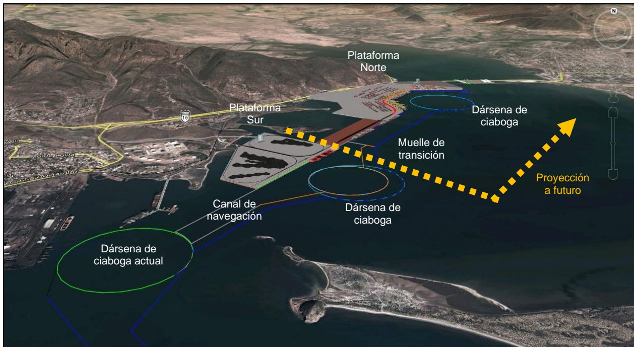
Figura 4. Vista de conjunto de plataforma norte, muelle de transición y plataforma sur del proyecto integral para la expansión del Puerto de Guaymas, Sonora.
