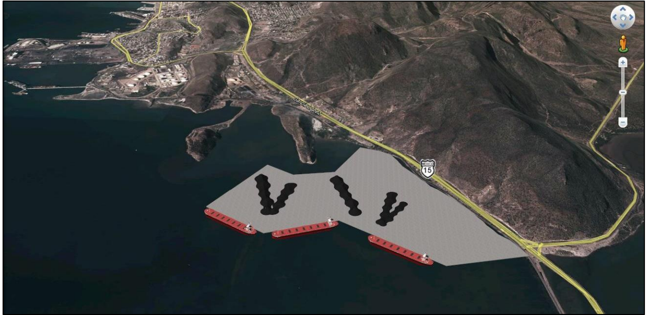
Figura 6. Plataforma norte unida a la configuración de la línea de costa para la expansión del Puerto de Guaymas, Sonora.
