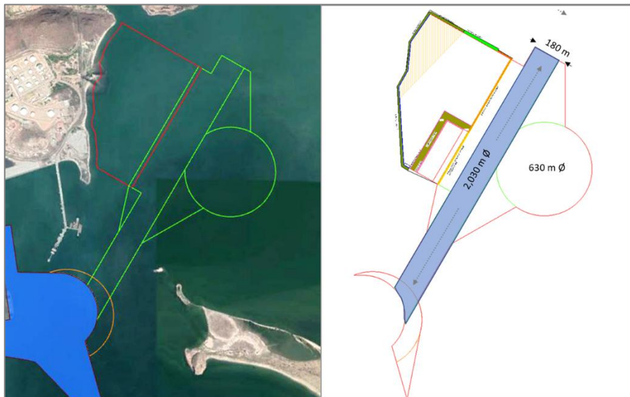
Figura 10. Trazo de las áreas de navegación que serán dragadas para la expansión del Puerto de Guaymas, Sonora.
