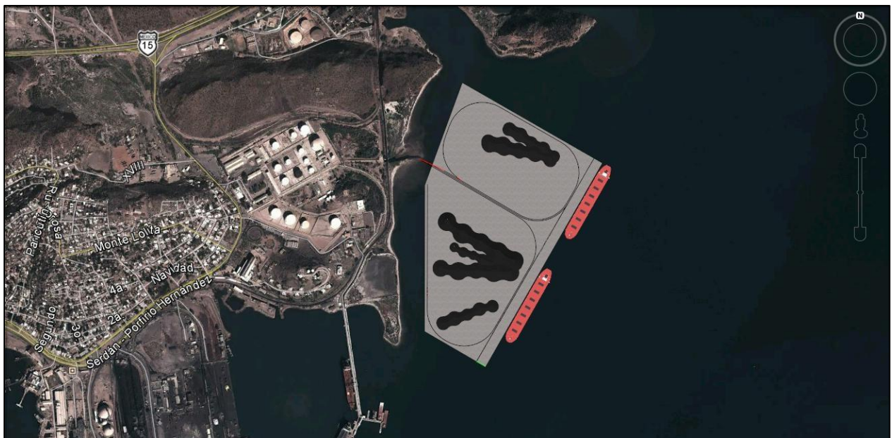
Figura 9. Plataforma sur con una separación paralela a la línea de costa para la expansión del Puerto de Guaymas, Sonora.
