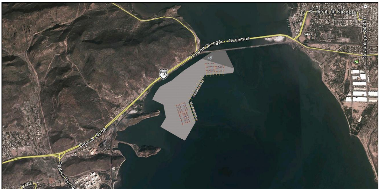
Figura 7. Plataforma norte con una separación paralela a la línea de costa para la expansión del Puerto de Guaymas, Sonora.
