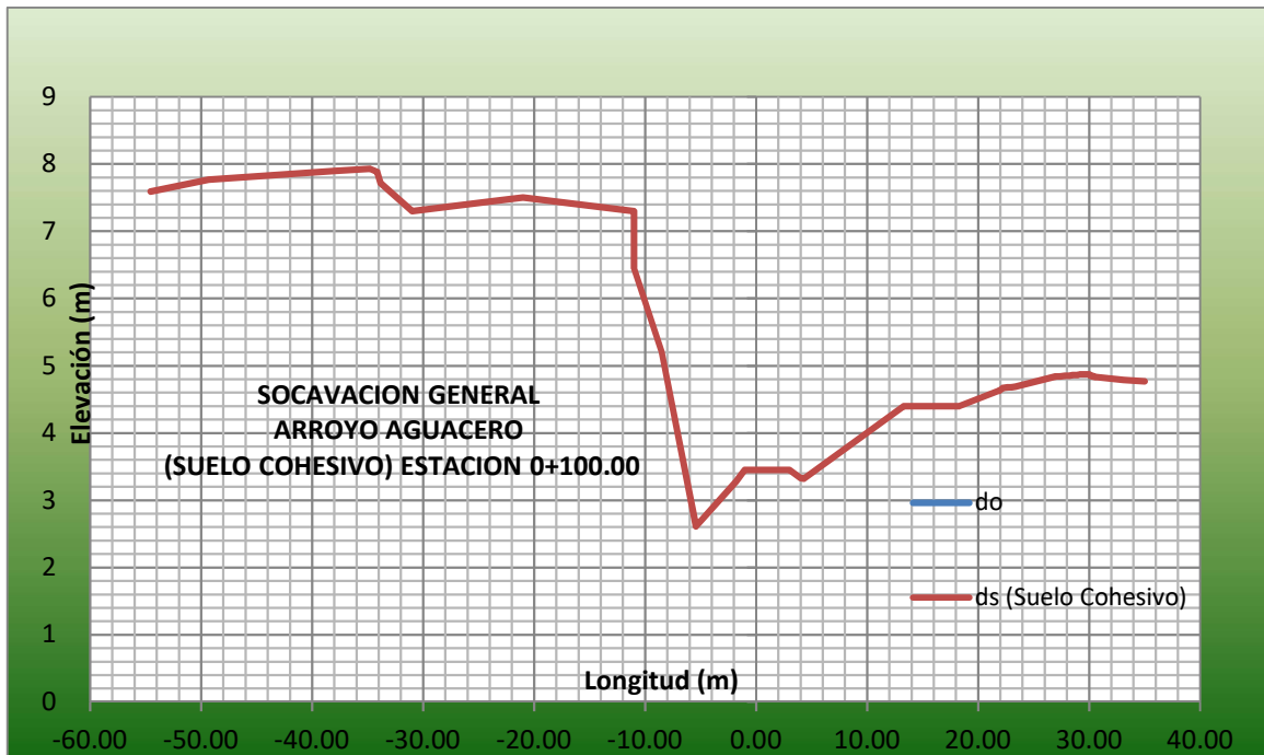
Gráfico II.80.- Grafica de la socavación general presentada en la estación 0+700 del arroyo Aguacero
