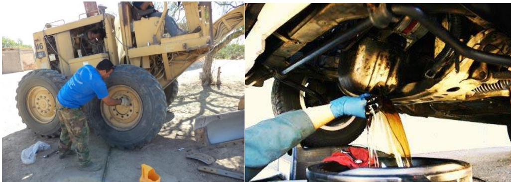
Reparaciones como cambio de llantas, cadenas, bandas, filtros aceites, purga de inyectores, trabajos de soldadura, entre otros, podrán ser ejecutados, utilizando para ello bandejas de recolección o cubiertas de geomembrana para evitar derrames accidentales sobre suelo desnudo.
