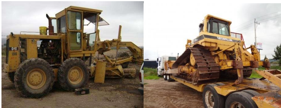
Aquellas reparaciones mayores deberán realizarse fuera de la obra, para lo cual se deberá contar con el apoyo de un Lowboy
