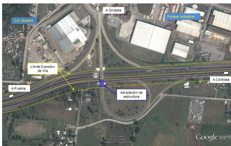
Figura II.47. Vista aérea del estado actual del sitio de ampliación y adecuación del entronque. Se puede ver: parte del Parque Industrial, el ancho del derecho de vía de la troncal del Proyecto y el sitio de ampliación o prolongación de la estructura del paso elevado.
