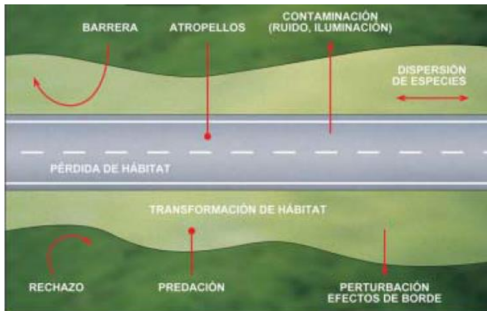
Figura VI.1. Impacto que genera este tipo de obra
