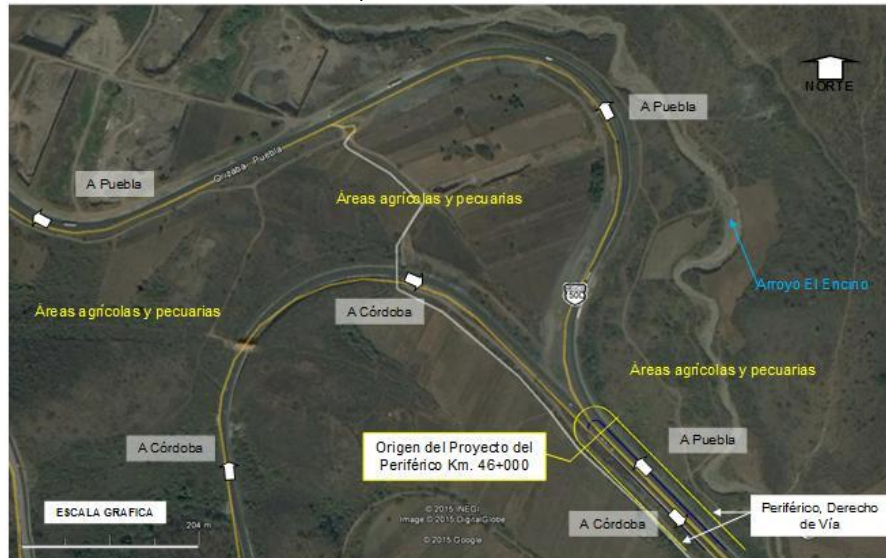
Figura II.35. Vista aérea del estado actual del sitio en el que se construirán: el entronque y los retornos en el inicio del proyecto, áreas en las que actualmente se realizan actividades agropecuarias, se observan el punto de origen de la troncal en el cadenamiento 246+000 de la actual Autopista.
