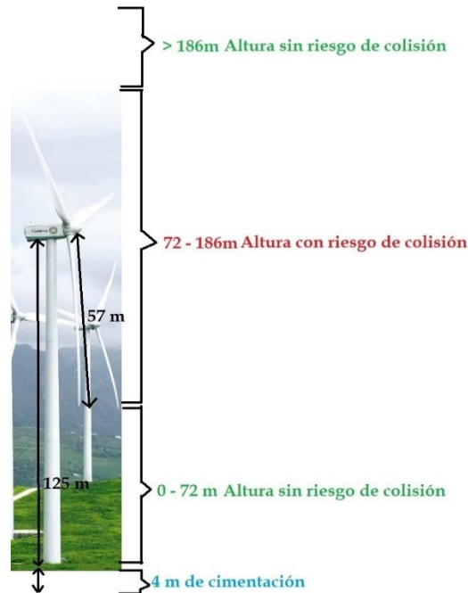
Figura 4.85. Alturas empleadas para el uso del espacio y de las situaciones de riesgo en el proyecto “Parque Eólico Sinanché Fase I y Fase II”.
