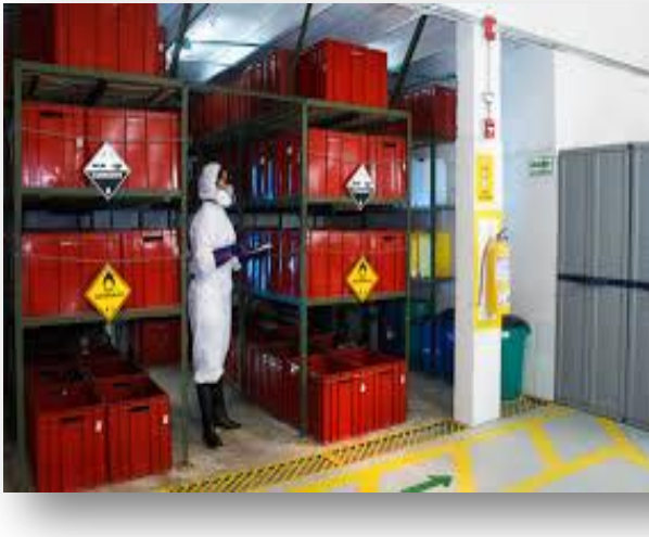
Figura VII.27 Identificación, separación y envasado de residuos peligrosos.
