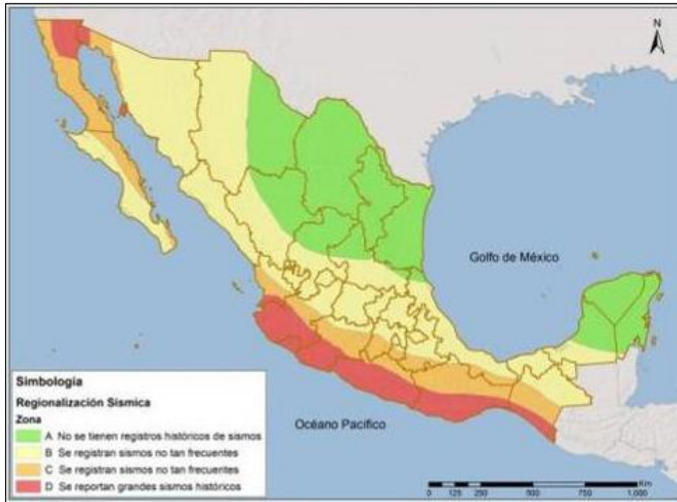
Fuente: CENAPRED. 2000. Clasificación de la República Mexicana de acuerdo con la regionalización sísmica.
