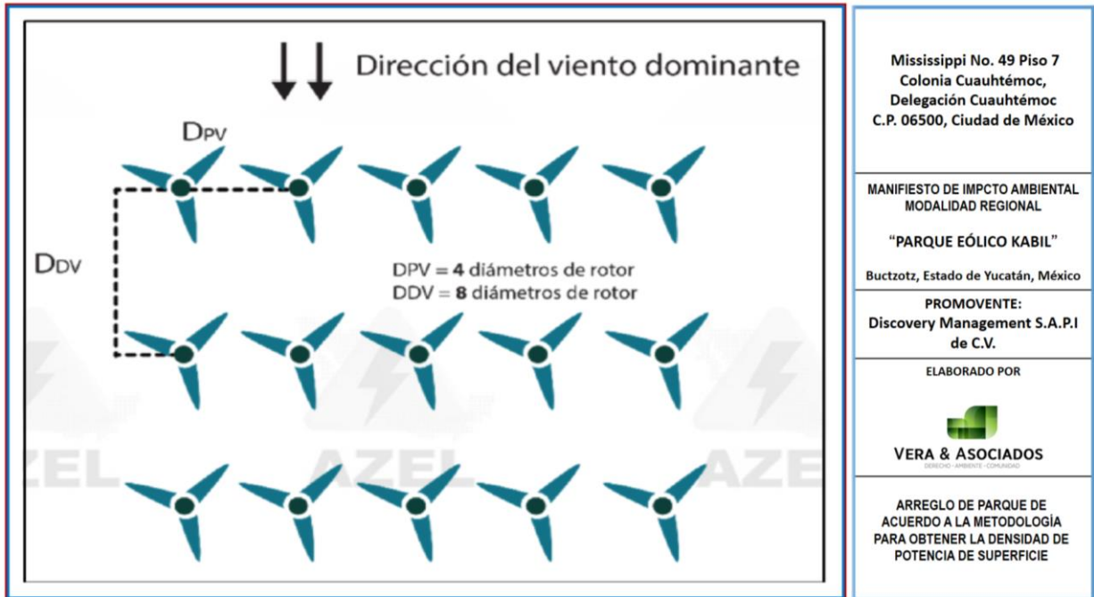
Figura VI.2. Arreglo del parque de acuerdo a la metodología para obtener la densidad de potencia por superficie
