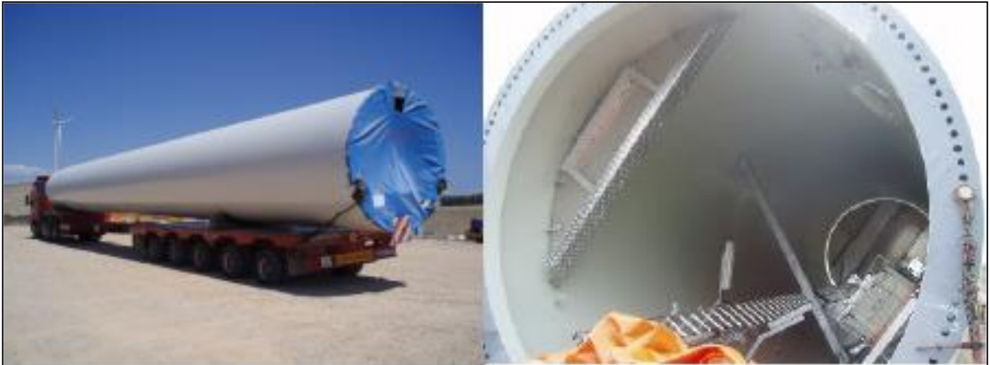
Figura II.14. Transporte tramos torre.
