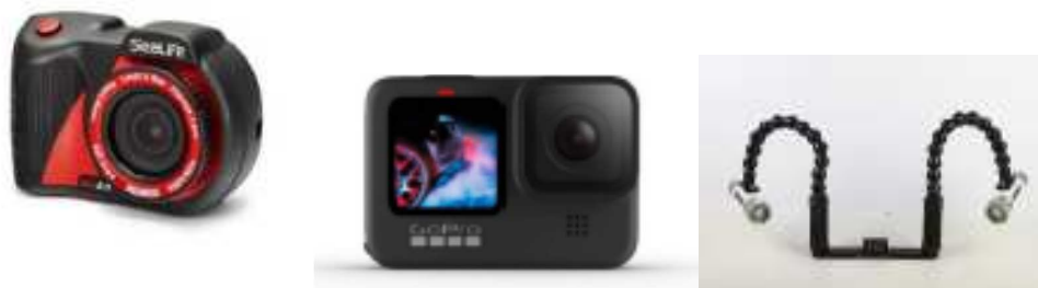
Figura IV.41 Herramientas de grabación utilizadas para la toma de videos a lo largo de cada transecto muestreado. De izquierda a derecha: cámara SeaLife Micro 2.0; GoPro Hero 5; soporte de cámara con estrobos.
