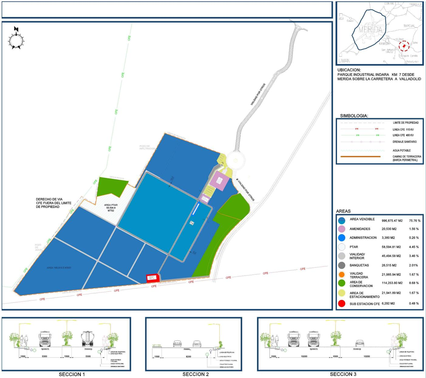
Figura II. 4 Plano del proyecto, en la cual se observa la distribución de los usos y los cortes de las vialidades.
