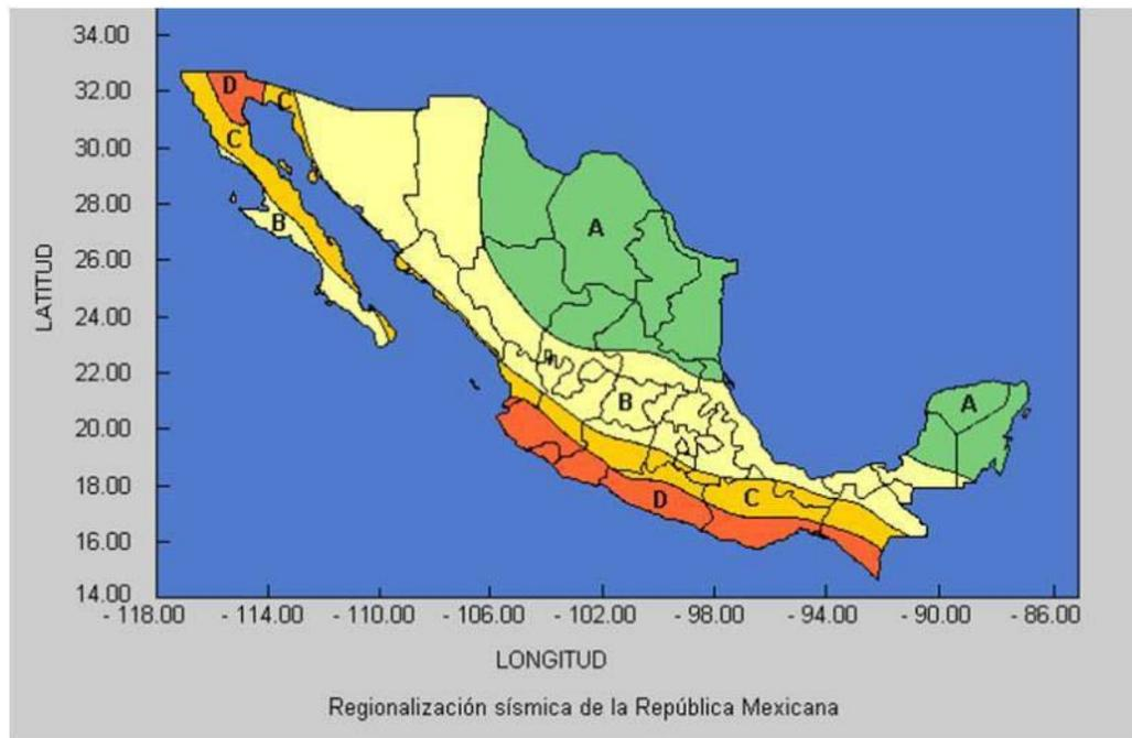
**Fig. IV.7** Fenómenos sísmicos A: Bajo riesgo sísmico B: Mediano riesgo sísmico C: Alto riesgo sísmico D: Muy alto riesgo sísmico.
