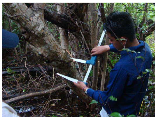
Figura 61. A cada ejemplar registrado se le media el diámetro normal a 1.3 m de altura, con la ayuda de la forcípula
